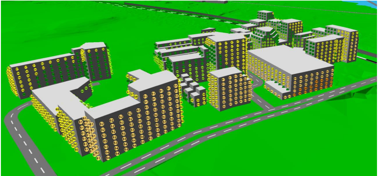
Kuva 8 Julkisivuihin kohdistuvat keskiäänitasot päivällä kaakosta
