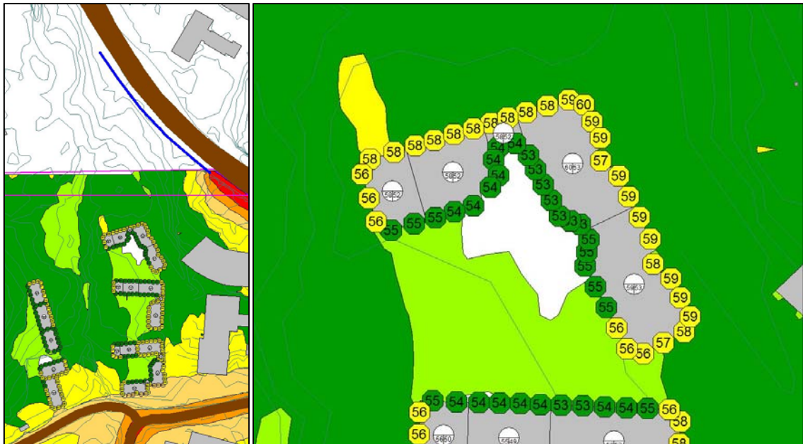
Kuva 6 Meluesteen sijainti melumallissa sinisellä viivalla (vasen kuva) ja korttelin 3 suurimmat julkisivumelutasot päivällä meluesteen kanssa (oikea kuva).
