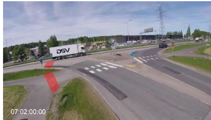
Kuva 10. RUBA-analyysissä käytettiin kahta tunnistinta (detector). Toinen sijoitettiin ajoradalle ja toinen yhdistetylle pyörätielle ja jalkakäytävälle. Kuvakaappaus RUBA-ohjelmasta.
