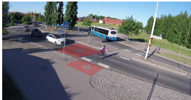
Kuva 13. RUBA-analyysissä käytettiin kahta tunnistinta (detector). Toinen sijoitettiin ajoradalle ja toinen yhdistetylle pyörätielle ja jalkakäytävälle. Kuvakaappaus videolta.
