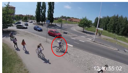
Kuva 15. Kuvakaappaukset videoilta konfliktitilanteesta. Pyöräilijä on muiden pyöräilijöiden takana ennen kääntymistään suojatielle, jolloin autoilijan on hankala havaita häntä.
