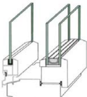
Kuva 3. MSE-ikkunan poikkileikkaus (lähde RT-38-10941)
