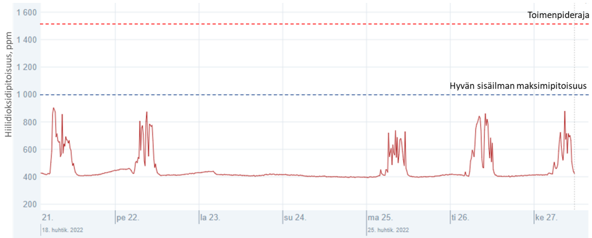
Kuva 1. Esimerkkikuva opetustilan 2222 hiilidioksidipitoisuudesta yhden viikon ajanjaksolta huhtikuussa. Pitoisuus ei nouse yli 1000 ppm, tällöin ollaan vielä sisäilmastoluokituksen mukaisella hyvällä tasolla.
