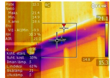
Katon kotelon ja ulkoseinän liittymä, ilmavuutokohta, johtunee puutteellisesta lämmöneristyksestä.
