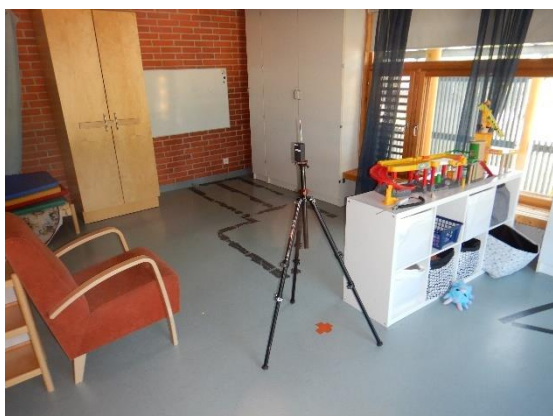
Kuva 6. Sisäilman VOC-mittaus tilassa 119.
