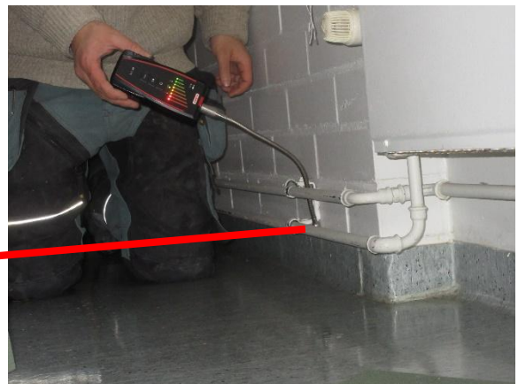
Selkeää ilmavuotoa nurkassa muovimaton ylösnoston kohdalla (tila 167)
