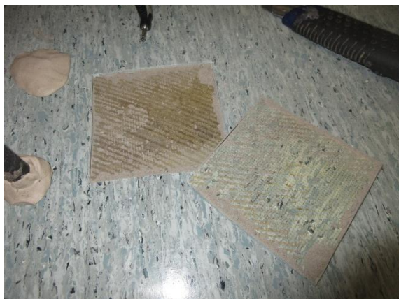
Kuva 5.16. BULK.03-AP näytteenottokohta. Liima-aineksessa tummentumaa (tila 164).
