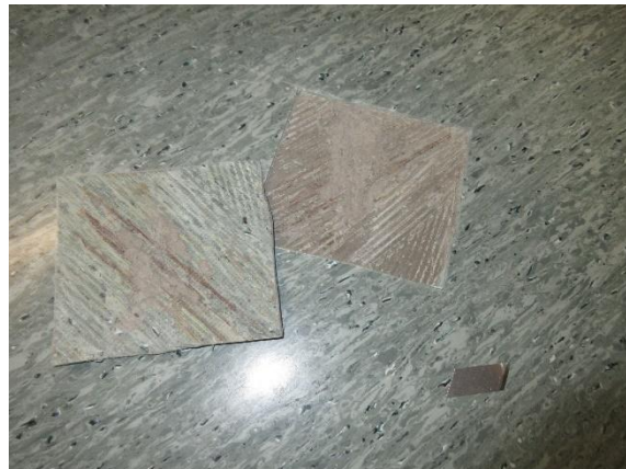
Kuva 5.17. BULK.08-AP näytteenottokohta. Liima-aineksessa tummentumaa (tila 157, ruokala).
