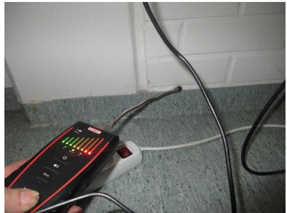
Selkeää ilmavuotoa nurkassa muovimaton ylösnoston kohdalla (tila 167)
