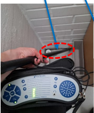
Selvää ilmavuotoa väliseinän kulmauksessa. Kaasu leviää myös lattialistan takana. Väliseinän ja ulkoseinän kulmauksessa on pientä rakoa. Lattialistan päälle on lisätty tiivistysmassaa lyhyelle matkalle (sininen nuoli).
