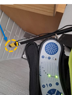
Selvää ilmavuotoa väliseinän kulmauksessa. Kaasu leviää myös lattialistan takana. Väliseinän ja ulkoseinän kulmauksessa on pientä rakoa. Lattialistan päälle on lisätty tiivistysmassaa lyhyelle matkalle (sininen nuoli).
