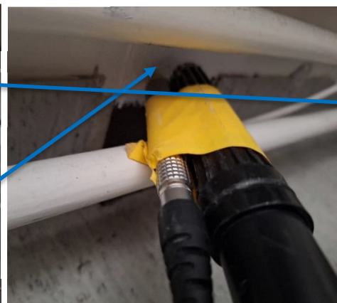
Selvä, jatkuva ilmapuoto ulkoseinän liikuntasauman kohdalla patterin takana.
