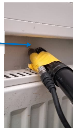
Selvä, jatkuva ilmapuoto ulkoseinän liikuntasauman kohdalla patterin takana.
