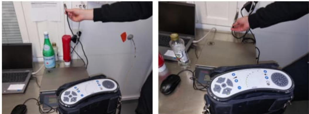
Kuva 54. Tilan 119 merkkiainekokeessa havaittiin vähäistä vuotoa tuuletusikkunan karmista ja saranan kohdalta.
