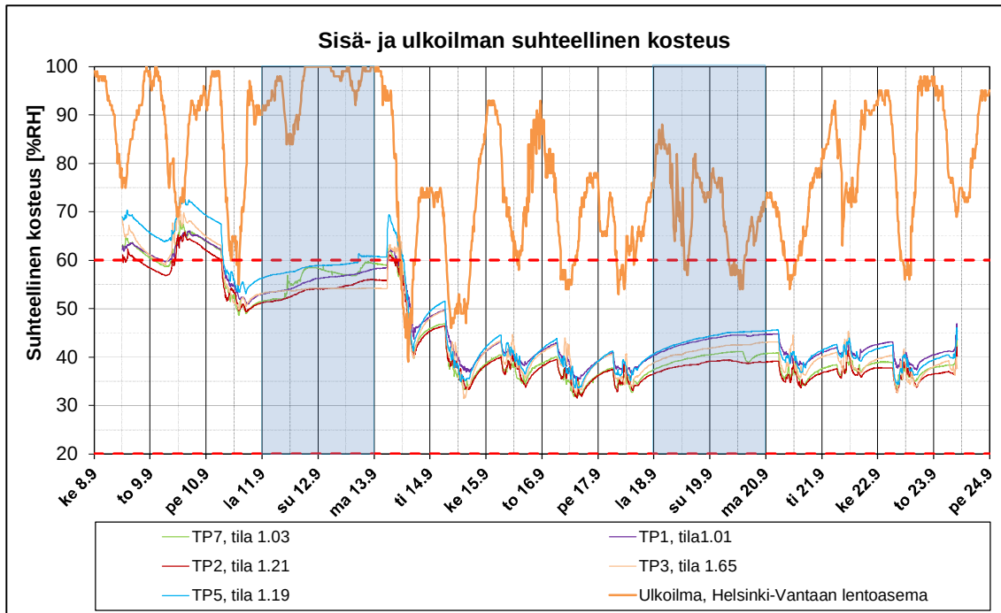
Kuvaaja 11. Rakennuksen sisäilman ja ulkoilman suhteellisen kosteuden seurantamittauksien tulokset. Kuvaaja suositellaan tulostettavaksi värillisenä. Sisäilman suhteellinen kosteuspitoisuus vaihteli välillä 31,5...73,1 %RH. Kuvaajaan on merkitty punaisella katkoviivalla Asumisterveysasetuksen viitearvo 20...60 %RH.
