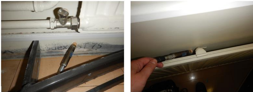
Kuva. Ikkunaliittymistä ja naulan rei'istä todettiin pistemäistä ilmavuotoa.
